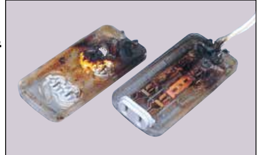
▲組立て不良によって焼けこげたテーブルタップ(右側のビスは、まったく締ってなかった) ※組立て1~2年後になりやすい
