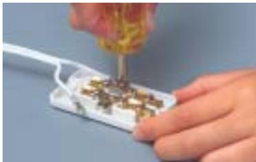
プラグと同様に2号のドライバーでしっかりねじを締める。ねじが軽く締まってから1/3以上ねじが空回りするまでしっかり締める。
